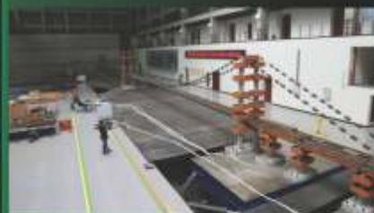
Prueba de Puente Suspenso: Múltiples Simuladores Sísmicos bi-axial Sísmicos bi-axial
