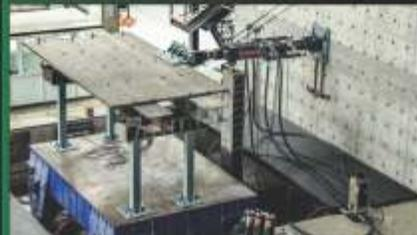
Prueba de rodamiento en puente: simulación híbrida en tiempo real con simulador sísmico bi-axial y actuador estructural
