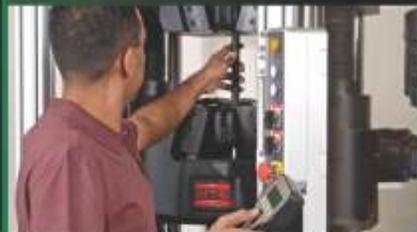
Prueba en barras de refuerzo de alta resistencia: sistema de prueba universal estático-hidráulico
